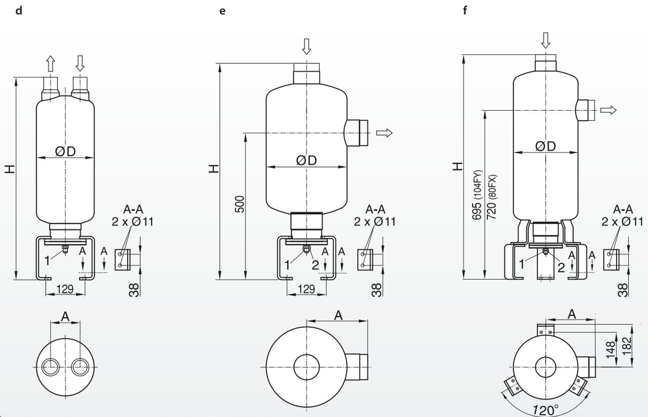
1) Ölrückführung 10x1 Bördel (Gewinde: 5/8"-18 UNF)
