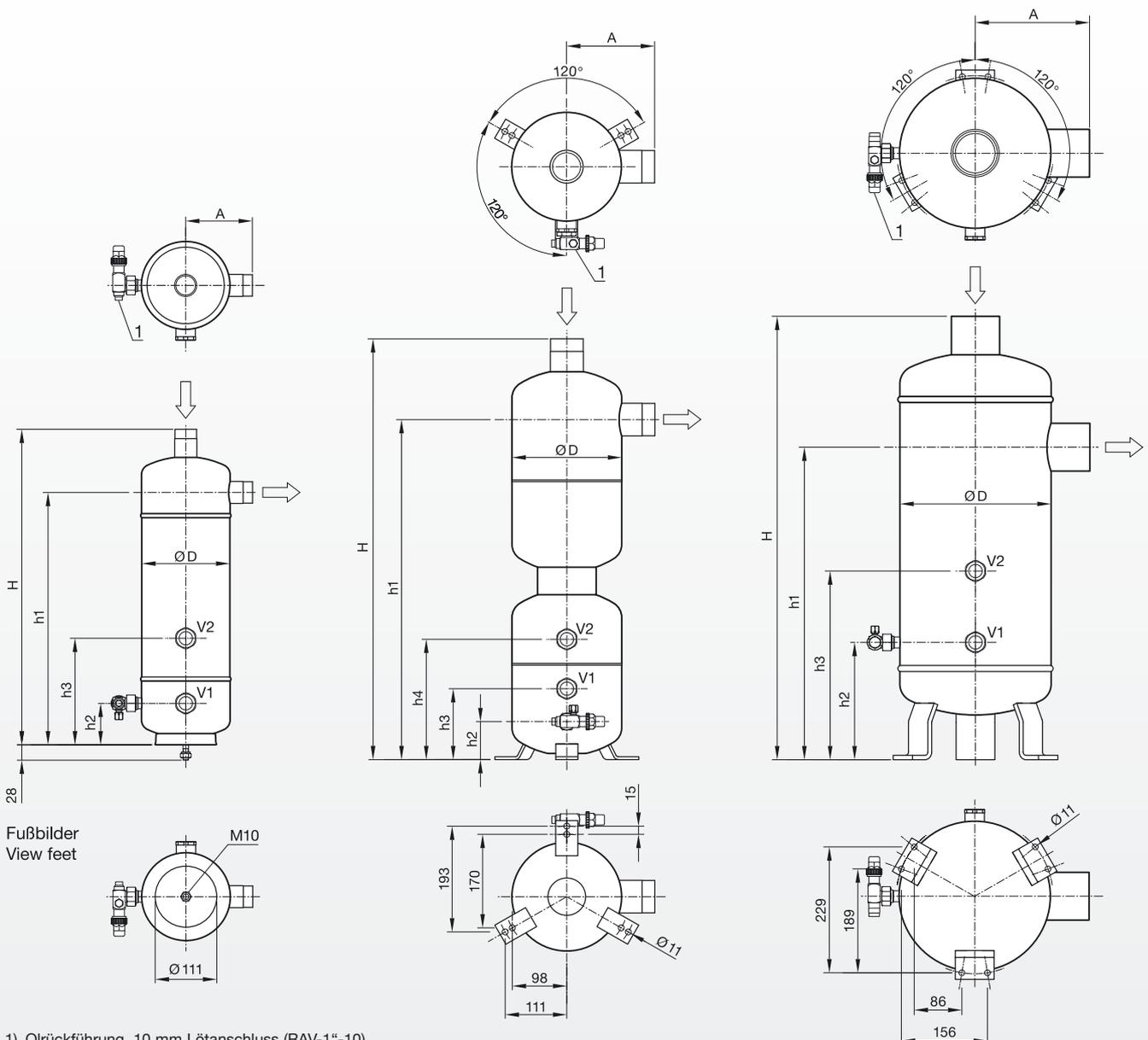
1) Ölrückführung, 10 mm Lötanschluss (RAV-1"-10)
