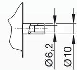
2) Anschluss für Füllstandsüberwachung,
