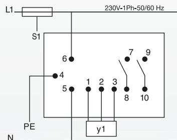
**Elektrischer Anschlussplan Wiring diagram**
