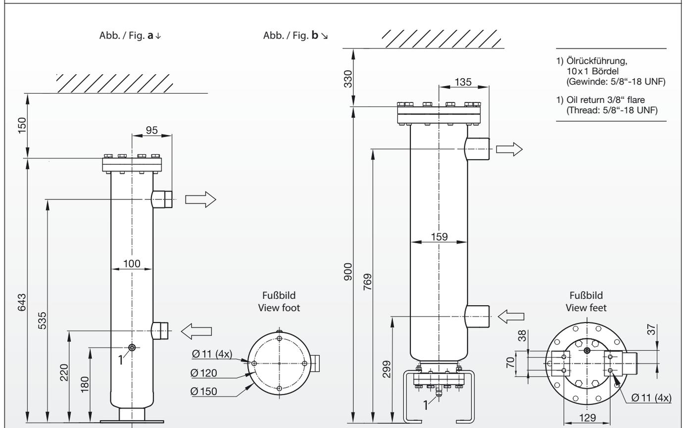
Ölabscheider BOS3-CDH → P<sub>smax</sub>: 130 bar
